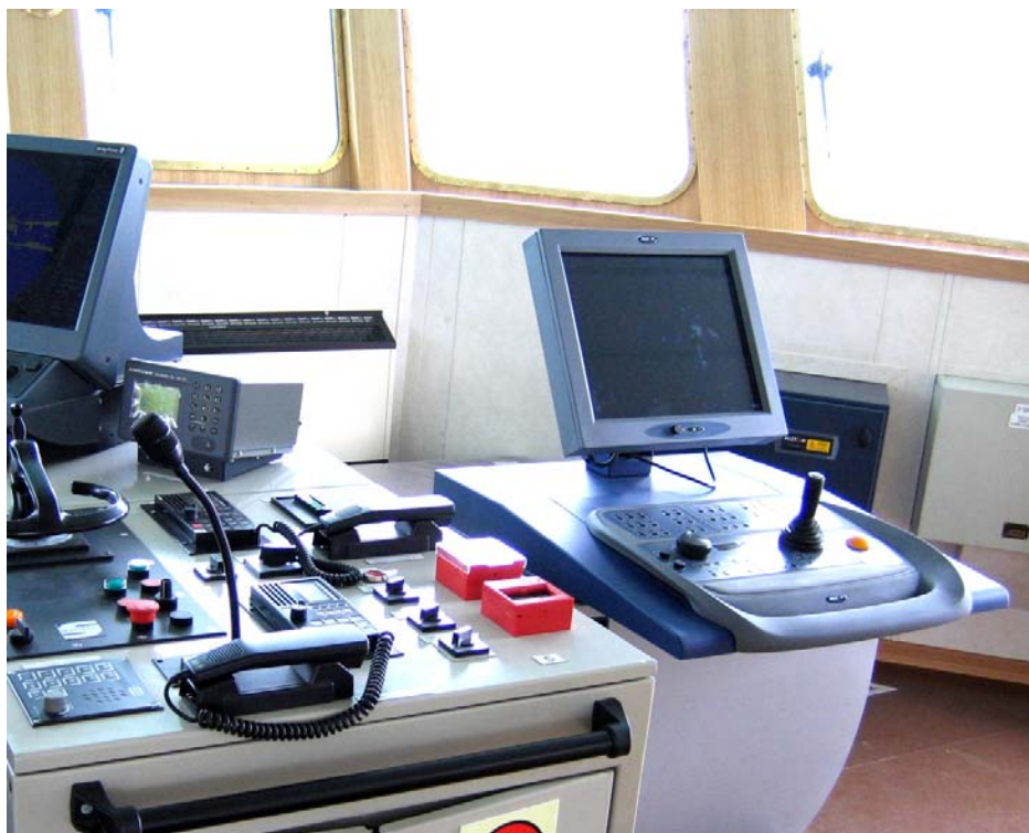
Rys. 11. Panel kontrolny systemu DP Fig. 11. DP control panel
