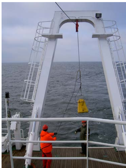
Rys. 3. Brama rufowa (DOR 3 t) Fig. 3. A frame (DOR 3t)
