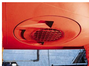
Rys. 9. Dziobowy pędnik wodno-strumieniowy Fig. 9. Waterjet bowthruster
