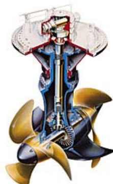
Rys. 7. Dwuśrubowy azymutalny pędnik rufowy - ster aktywny Fig. 7. Dual azimuthal active rudder-propeller
